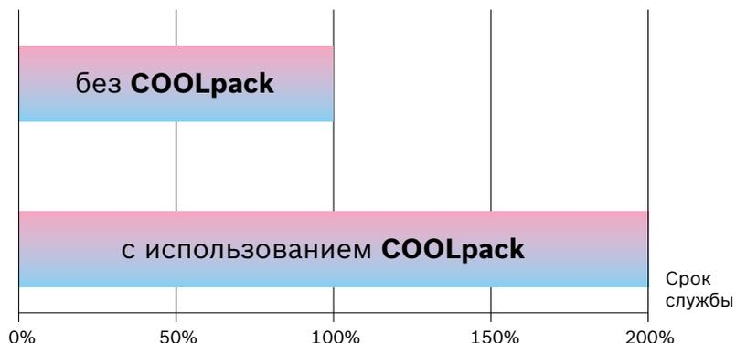
Перегрев – причина выхода из строя ячеек аккумулятора. Технология «**Bosch COOL pack**» – специальный радиатор, который эффективно отводит тепло от ячеек через нижнюю часть корпуса аккумулятора, уменьшая перегрев. Результат: аккумулятор остается холодным и работает дольше!
